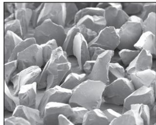
Unterschiedlich in Größe und Form sowie unregelmäßig verteilt. Das Ergebnis sind kürzere Standzeiten des Schleifmittels sowie Spannungsrisse und Verfärbungen im Material:
