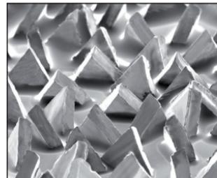
Präzise geformte, einheitliche Schleifkörner, gleichmäßig verteilt und einheitlich ausgerichtet. Das Ergebnis ist eine maximale Abtragsrate, ein perfektes Oberflächenfinish, ein schneller und kühler Schliiff sowie geringer Materialverzug:
