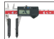
Měření vzdáleností průchozích otvorů
